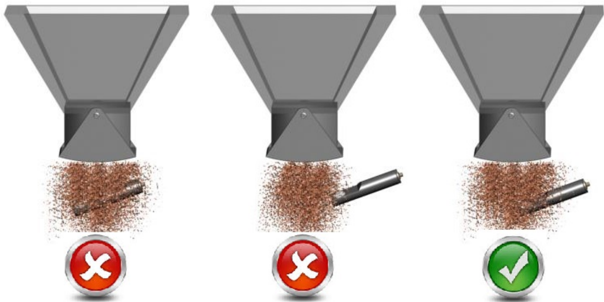
Картина 4 - Примеры правильной и неправильной сборки в бункере
