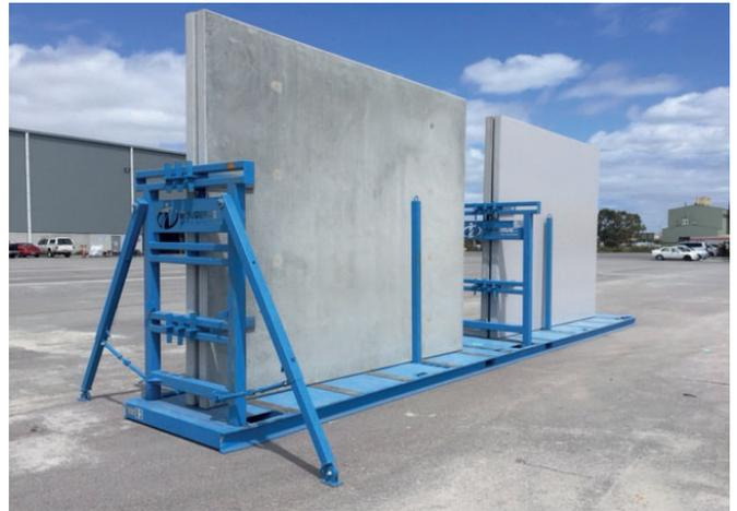
Стеновые элементы, изготовленные в кассетной опалубке Теспосот, отличаются безупречным качеством и отделкой поверхности. Обе стороны панелей имеют гладкую поверхность (источник: BGC)
