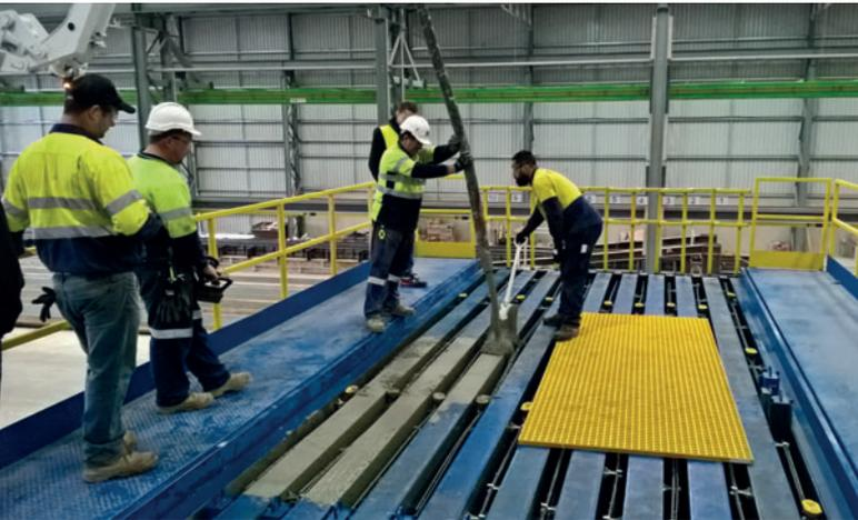
Кассетные формы для сборных ж/б стеновых элементов обеспечивают высокую производительность в условиях ограниченного пространства. Компания BGC выпускает до 20 стеновых панелей за цикл
