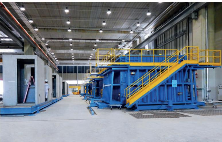
С помощью четырех опалубочных кассет компания Greyform выпускает объемные модули, которые отделываются под ванные и кухни
