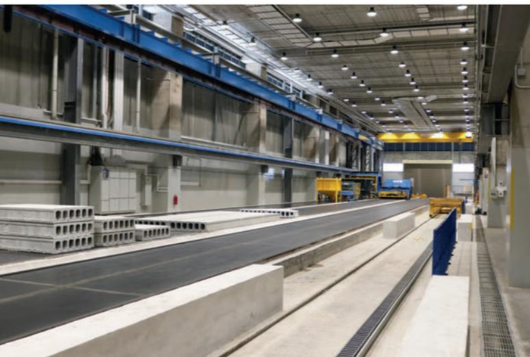
Для производства преднапряженных перекрытий и элементов компания Greyform использует слипформер типа S-Liner T40 на трех дорожках
