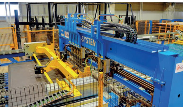
Требуемая арматура изготавливается на втором этаже фабричного корпуса. Сеткосварочная установка M-System Evolution была разработана для гибкого эксплуатационного применения и поэтому оптимально вписывается в общую производственную концепцию
