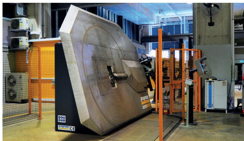
Автомат для сварки хомутов EBA S16 Plus 3D используется для производства стержней, изогнутых стержней, простых и объемных хомутов
