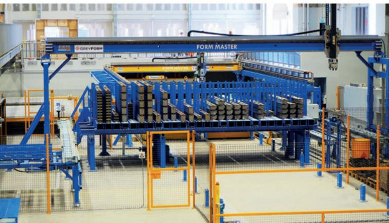
Автоматизированная линия циркуляции поддонов (на фото изображен опалубочно-распалубочный робот) позволяет компании Greiform соблюдать точные сроки поставок и строгие требования к качеству при небольших трудозатратах
