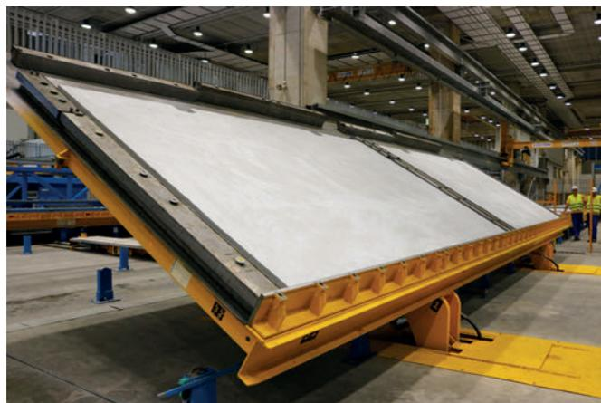
По завершении производственного цикла готовые сплошные стеновые панели или плиты перекрытия снимаются с одного из 48 поддонов и автоматически перемещаются на склад
