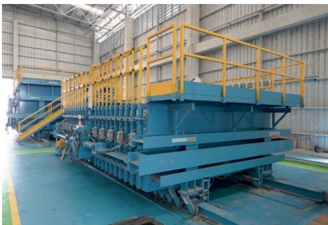
Новая кассетная опалубка используется на заводе Sansiri для производства перегородок и элементов ограждений
